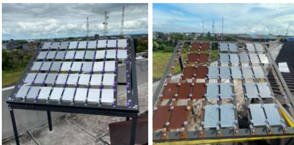
Figura 1. Estación de corrosión instalada en la cubierta del bloque 11 de la Universidad Tecnológica del Chocó (Antes vs Después).
