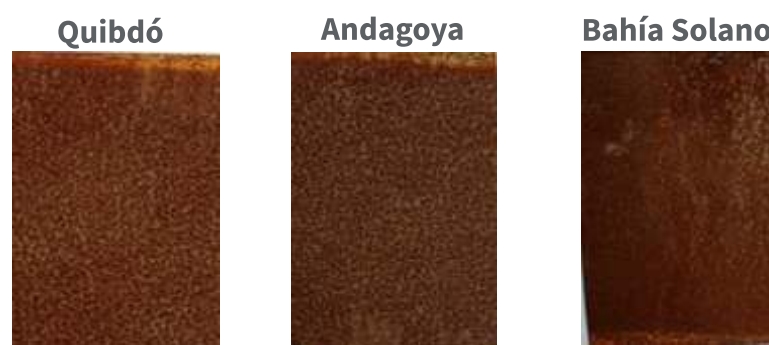
Figura 3. Avance de la corrosión atmosférica de placas expuestas por 4 meses
