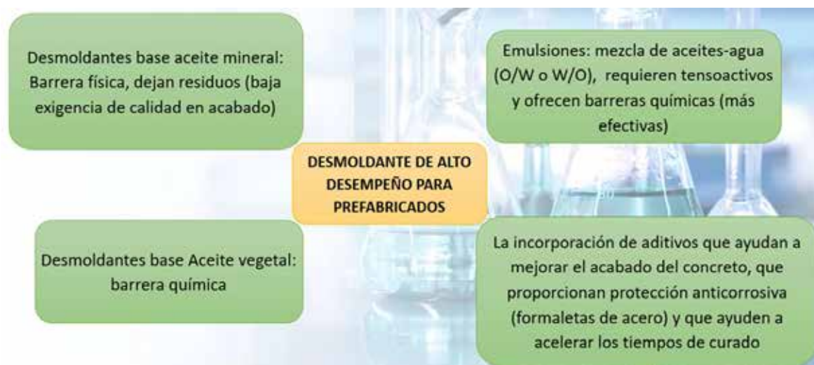
Figura 17. Posibles soluciones de desmoldantes para prefabricados.
