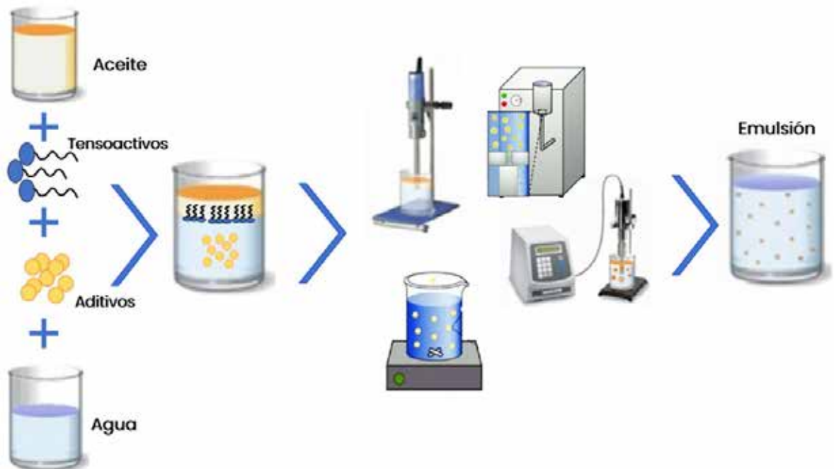
Figura 20. Proceso de preparación de la emulsión.
