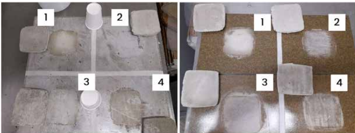
Figura 24. Izquierda: Desencofrado en formaleta metálica. Derecha: Desencofrado en formaleta fenólica.
