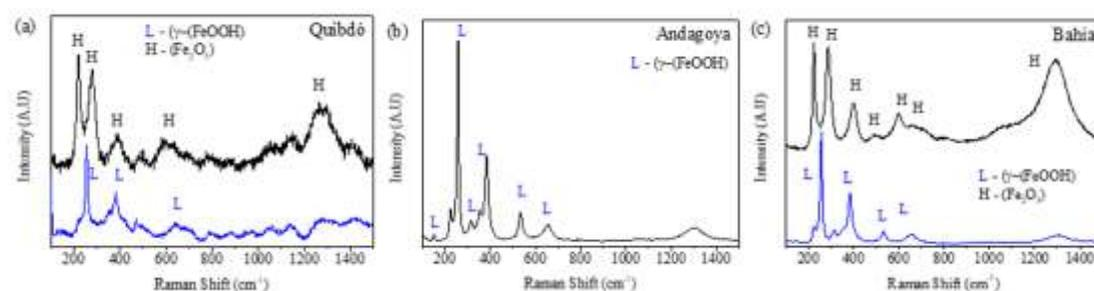
**Figura 2.** Espectros Raman de los óxidos de hierro formado sobre las muestras después de 4 meses de exposición Lepidocrocita (L), Hematita (H). (a) Estación de Quibdó. (b) Estación de Andagoya. (c) Estación de Bahía Solano.
